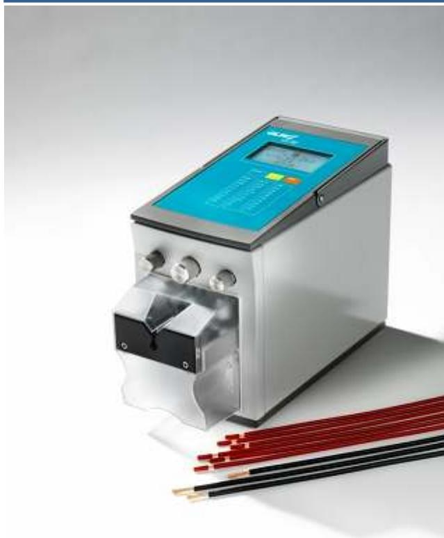
La CS-60 est une machine de dénudage de fil adaptée pour des câbles de section de 0,08 à 6 mm<sup>2</sup> et avec des longueurs de dénudage allant de 3 à 20 mm.
