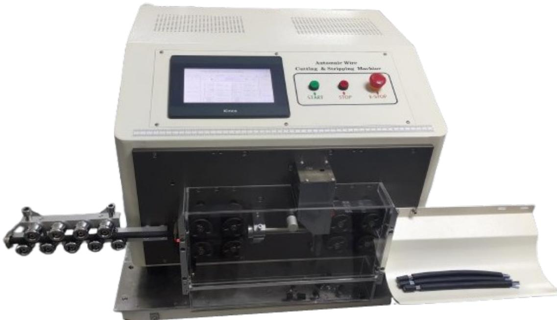
La TSC25+ est une machine de coupe et de dénudage / dégainage pour les câbles unipolaires et les multipolaires. Un kit de guides fil facilement interchangeables est fourni avec la machine.
